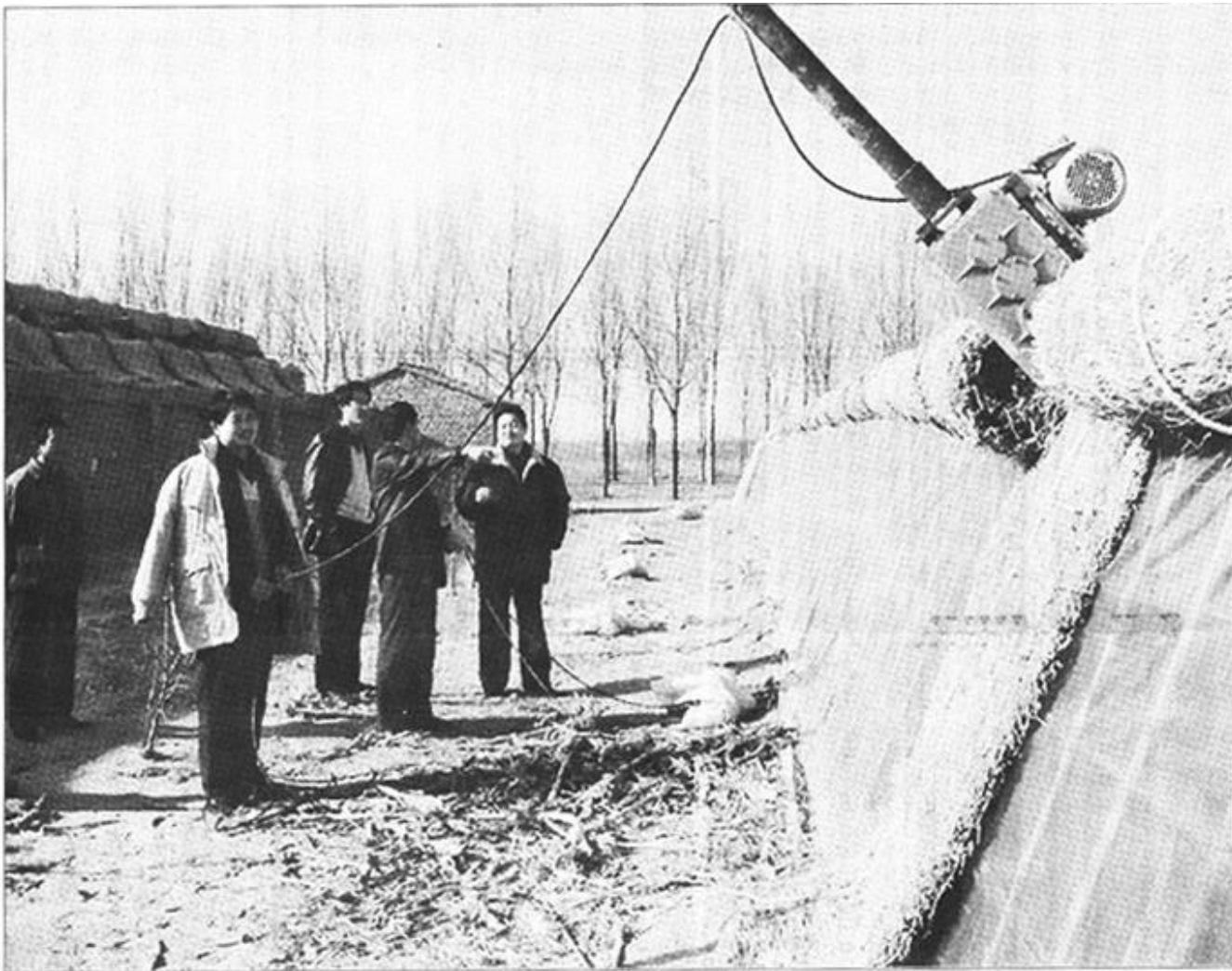
河口区义和镇科技副镇长卢振波引进推广蔬菜大棚电动卷帘机,不仅提高了工作效率,还减轻了劳动强度,引起群众的极大兴趣。(徐兆鹏 摄)
